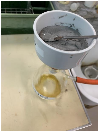
Fig.3 硫酸カルシウムの沈殿をろ過している様子
