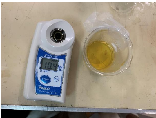
Fig.4 作成した溶液を糖度計で測っている様子
